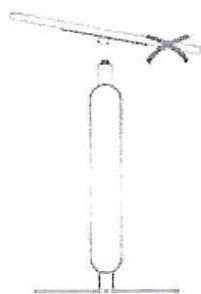
Столешницу не следует устанавливать в наклонном положении, она должна быть установлена горизонтально
